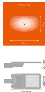
**Technische Daten Ledvance LED-Straßenbeleuchtung Flex mittel RV25ST Grau 80W 10550lm 25x145D - 727 | IP66 - Asymmetrisch**
