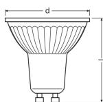
**Technische Daten Osram Parathom LED-Spot GU10 PAR16 8.3W 575lm 60D - 940 | Höchste Farbwiedergabe - Dimmbar - Ersatz für 80W**
