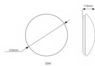
**Technische Daten LED-Wand- und Deckenleuchte Weiß 22W 2075lm - 840 | 410mm - IP44**
