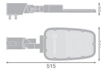
**Caractéristiques Ledvance Projecteur LED Area Moyen Gris 65W 8450lm 160x58D - 730 | IP66 - Symétrique**
